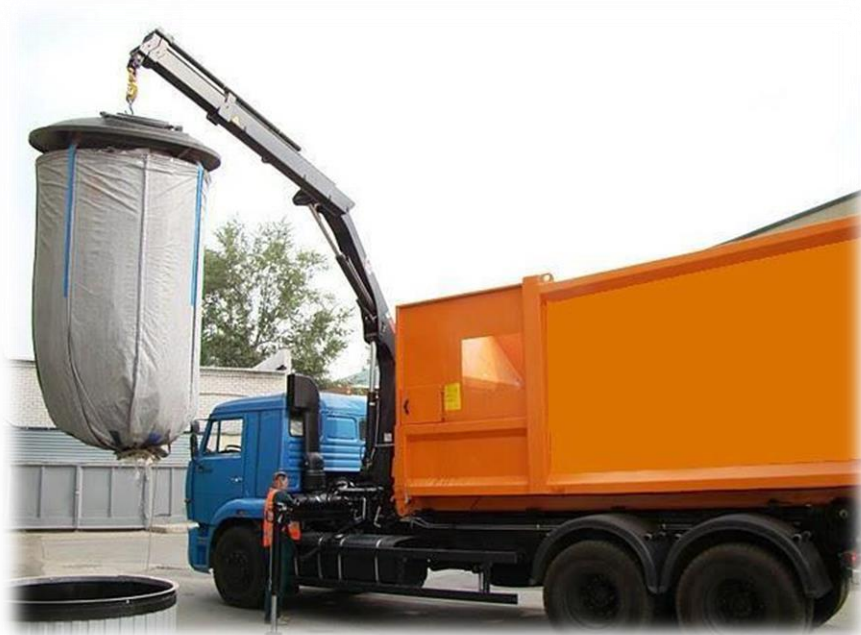
Опустошение заглубленного контейнера.
