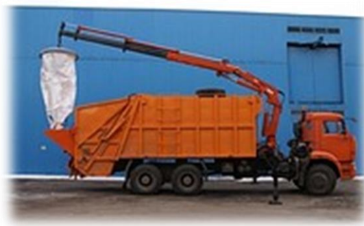
Мусоровоз с крано-манипуляторной установкой Amco Veba 810-2S
